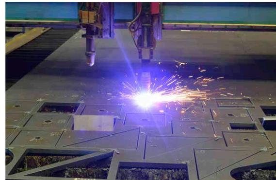
Mit modernen Brennschneideanlagen hat Debrunner Acifer 800 Massbleche und 110 Breitflanschträger produziert.
